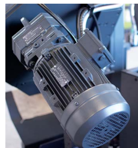
Hohe Leistung auch bei langsamem Lauf: Der drehmomentstarke, langlebige Kegellrad-Getriebemotor hat einen hochwertigen Frequenzumrichter, mit dem sich die Drehzahl des Motors stufenlos verstellen lässt.
